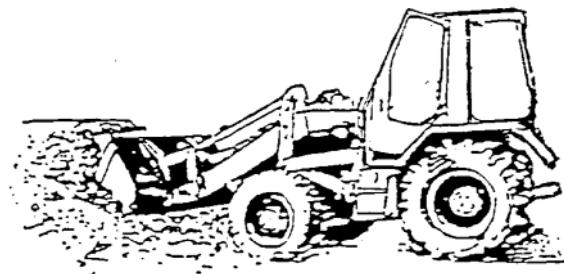
Für die Operationen zur Füllung von losen Haufen, soll man den Greifer positionieren, sodass die Schneide parallel zum Boden ist.
